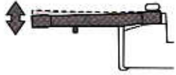
フロントロワームL Front lower arm L Vorderer unterer Arm L Triangles inférieurs avant G
