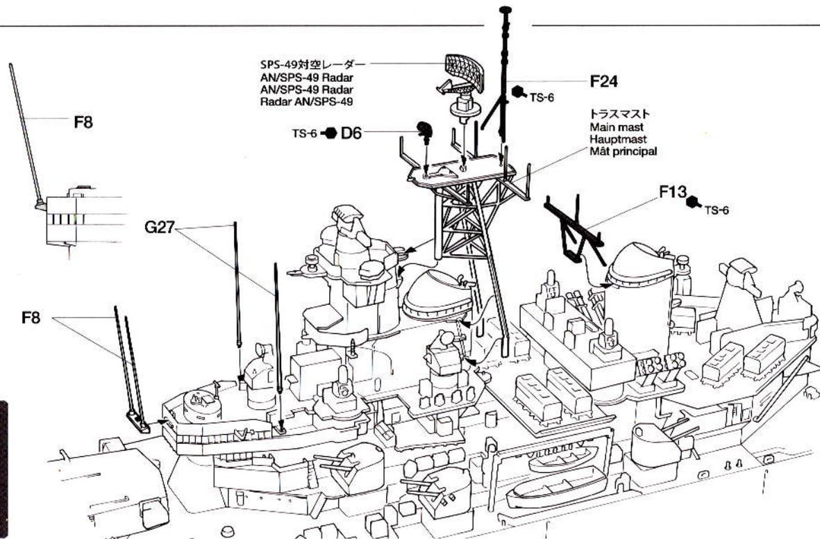
ディスコーンアンテナの取り付け
