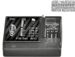
500501534 Ersatzempfänger / Receiver Reflex Wheel PRO3 2,4 GHz
