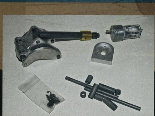
Die Einzelteile der Kippmechanik sind schnell zusammengebaut
