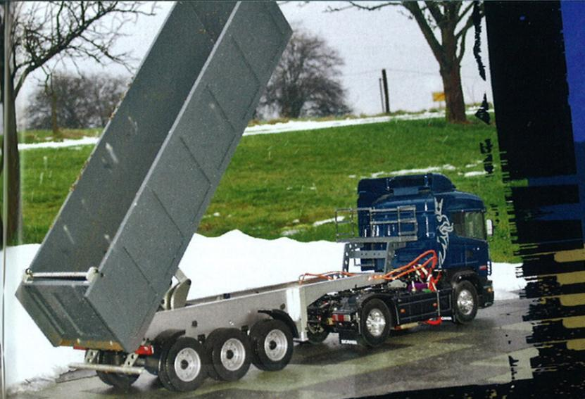
Der Kipperaufbau ist schnell und unspektakulär zusammengeklebt. Boden, Seitenwände und Frontpartie sind verzahnt, man trägt zuerst entlang der Verzahnung Klebstoff auf und steckt die Laschen ineinander. Die Aussparungen und Zapfen der Verzahnung werden dann im nächsten Schritt durch ein Seitenteil mit Sicken und Streben verdeckt. Im zusammengebauten Zustand ergeben sich so keinerlei Spalten, die aufwendig zugespachtelt und geschliffen werden müssten. Sehr durchdacht!
